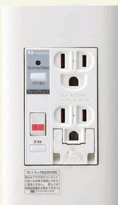
冷蔵庫や大型家具の裏になつてしまっているコンセントはなかなか掃除しにくいもの。V.O. 31でも紹介した「トラックキング現象」プラグに溜まったホコリに湿気が付着して発熱、発火に至る現象が心配になります。そこでオススメしたいのがこのコンセント。トラックキング現象の初期段階を検知すると自動で回路をしゃ断、ブザーとランプでお知らせしてくれます。コンセント交換は、電気工事の有資格者が行う必要があります。ぜひ新栄総合管理へご相談ください。
